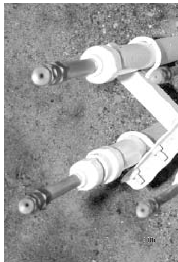
散水装置で毎時15〜200mmの雨を噴射
