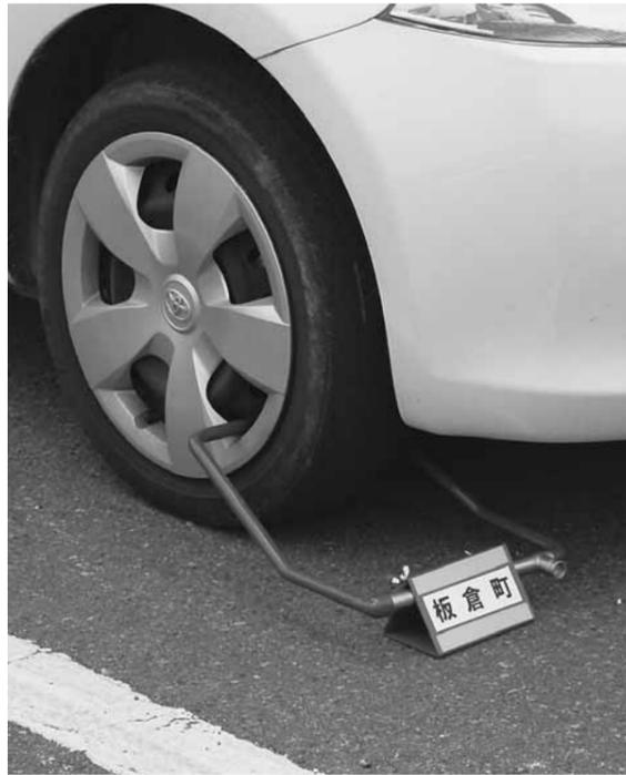
のタイヤを固定する鉄製の器具で、これを装着された車は走行不能となります。これにより、自動車(軽自動車、バイクなどを含む)の差押えが効果的に行えるようになります。
